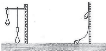
Рис. 2 Монтаж поплавкового выключателя MS M2
